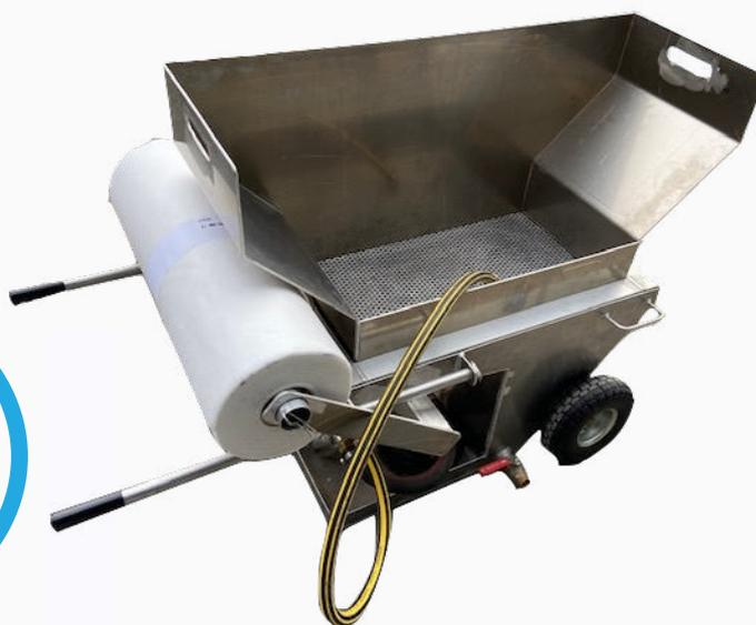
Petite station portable équipée de roues et de bras permettant ainsi de la déplacer facilement en limitant les risques de troubles musculo-squelettiques.
