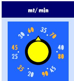
Option : variateur de vitesses (convertisseur ou inverter). Potentiomètre de sélection de la vitesse de coupe de la lame : de 20 à 45 m/min. pour la 1<sup>a</sup> Vit. et de 35 ou 90 m/min. pour la 2<sup>a</sup> Vit.
