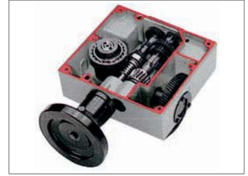
Code 30003: Descente automatique mécanique de la broche 3 vitesses 0,05 – 0,1 – 0,2 trs/min (R32 – R40).
