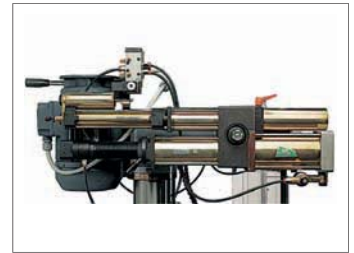
Cod. 30019: Descente automatique hydropneumatique UR80 (R32 – R40). Cod. 40010: Descente hydropneumatique UR100 (R45). Course automatique de la broche 105mm avec retour rapide. Vitesse d'avance: 5÷2500 mm/1'. Effort de poussés a 6 bar: 400 Kg
