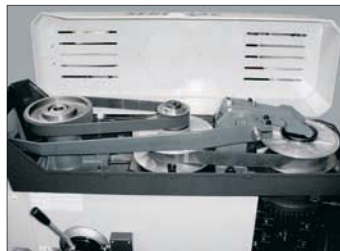
VS: Variateur mécanique simple
